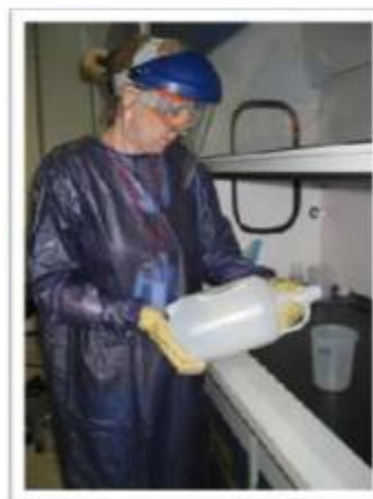
Correct Pouring Position
